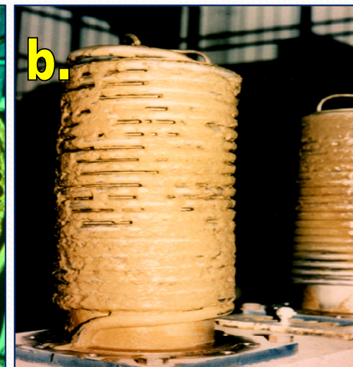
(a) Pakietowy wymiennik ciepła, (b) Kamień wodny i biofilm z różnymi mikroorganizmami.
